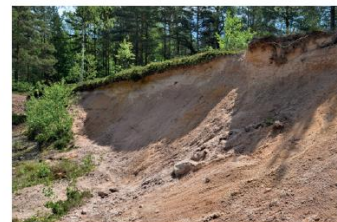
Kvalitní písek ze zvětralé vrstvy triasových pískovců poskytoval písník u Březové (uprostřed vpravo)
